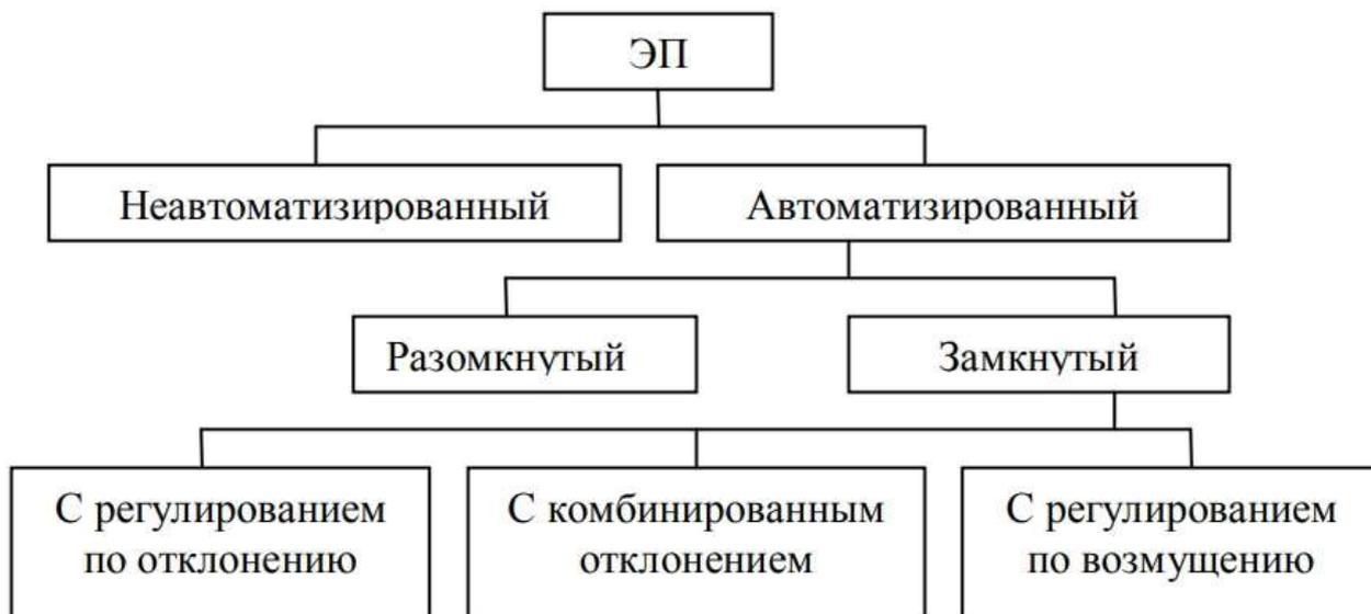
Рис. 2. Классификация электроприводов по степени их автоматизации
